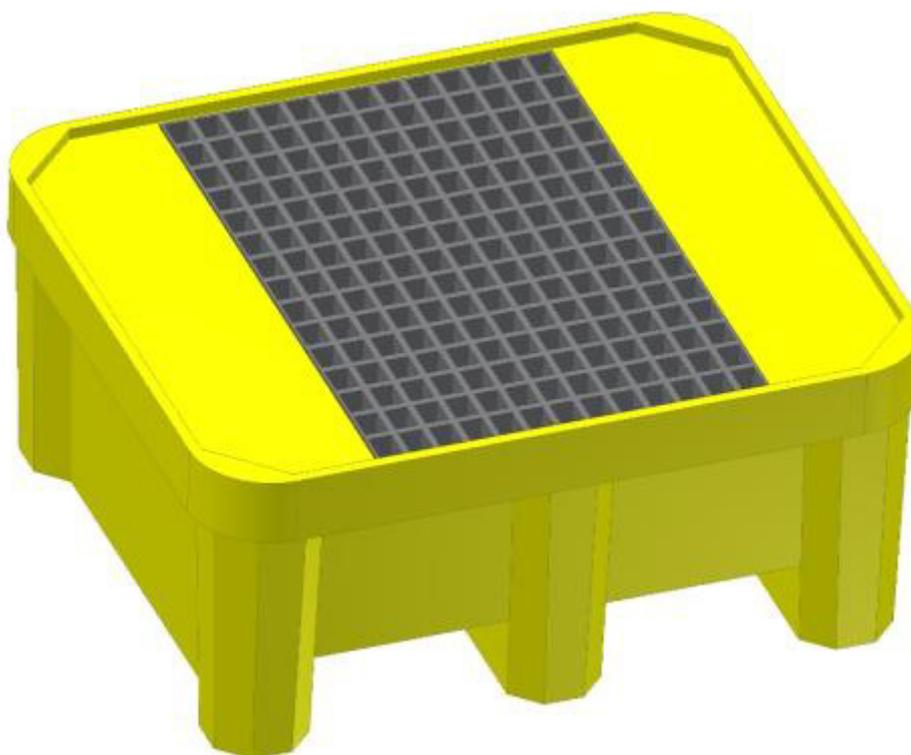
Vasca di sicurezza dotata di griglia asportabile in polipropilene, struttura monolitica senza giunzioni, realizzata in polietilene lineare di colore giallo, idonea per lo stoccaggio di fusti metallico/plastici. Pallettizzata e movimentabile a vuoto con transpallet o carrello elevatore.
