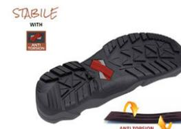
L'utilizzo del cambione è finalizzato a fornire alla calzatura un'estrema stabilità su ogni terreno. Particolarmente indicato per il settore edile, dove i rischi causati da terreni sconnessi e bagnati sono maggiori, questa tecnologia è inoltre molto utile per chi lavora sulle scale (imbianchini, pulizie vetri, muratori) in quanto aumenta la stabilità nella parte centrale della pianta.
